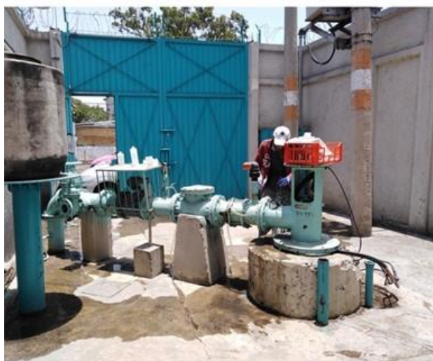
Figura 3-4 Medición de parámetros físico-químicos de campo en el pozo Xochinahuac
