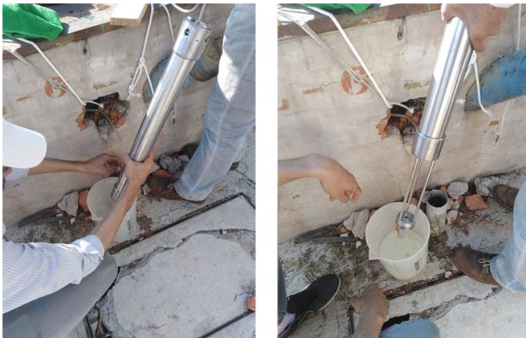
Figura 2-8 Toma de muestras en la vertical
