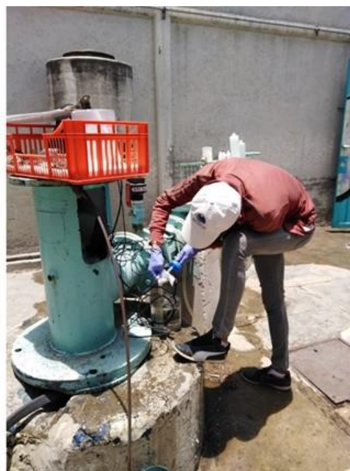
Figura 3-4 Medición de parámetros físico-químicos de campo en el pozo Xochinahuac
