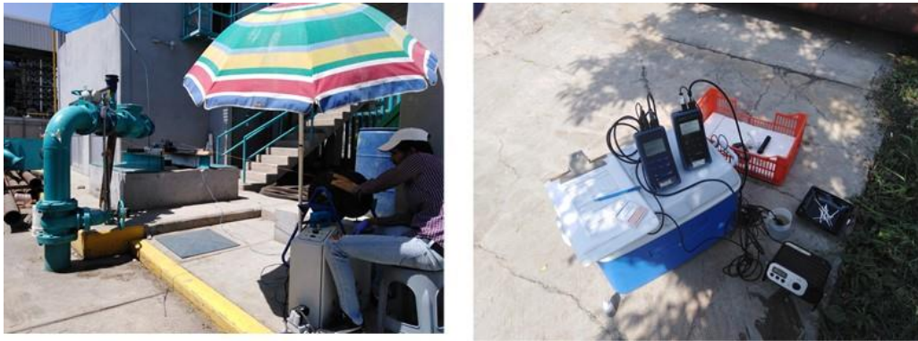
Figura 2-3 Medición de parámetros físico-químicos de campo en el pozo Santa Catarina 5
