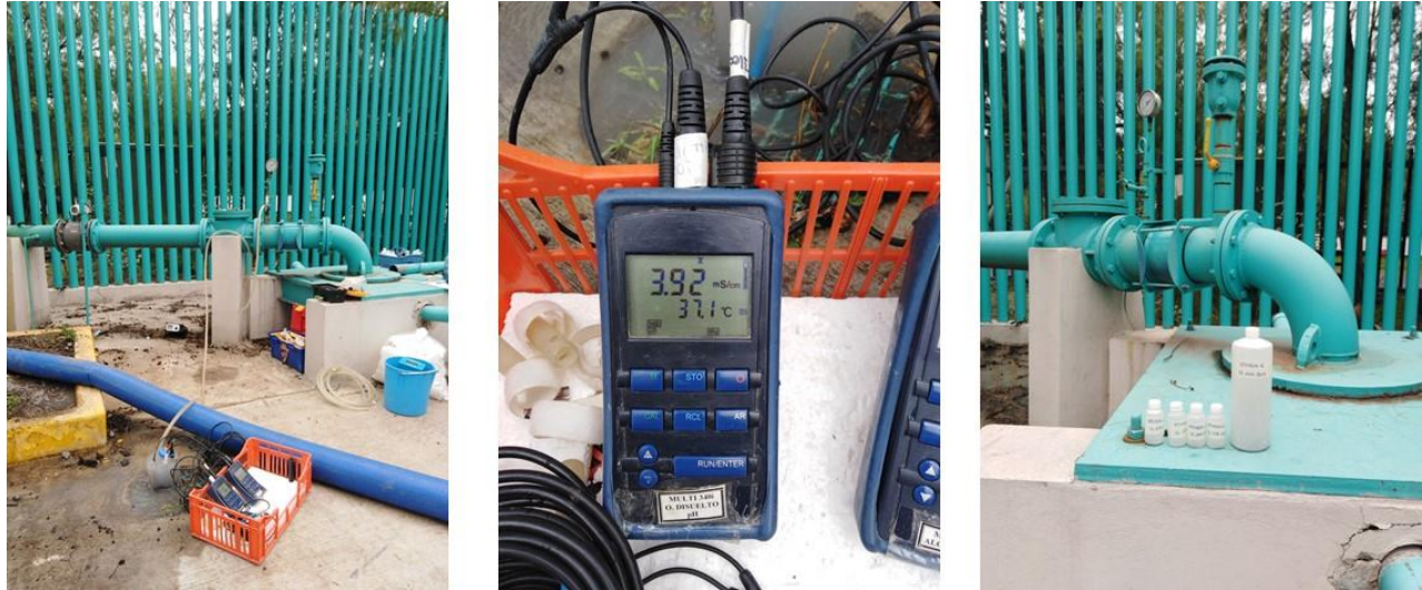
Figura 5-2 Medición de parámetros físico-químicos de campo y toma de muestras en la descarga del pozo.
