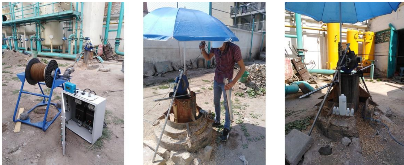
Figura 4-2 Medición de parámetros físico-químicos de campo y toma de muestras en el pozo Jardines del Pedregal 5B
