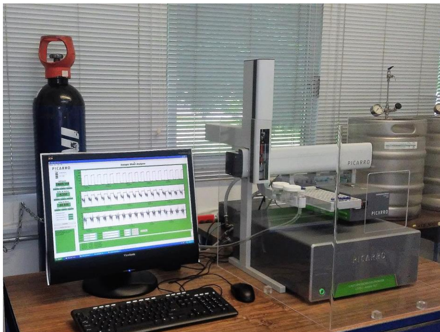
Figura 2-22 Analizador de isótopos de agua Picarro L2110-i
