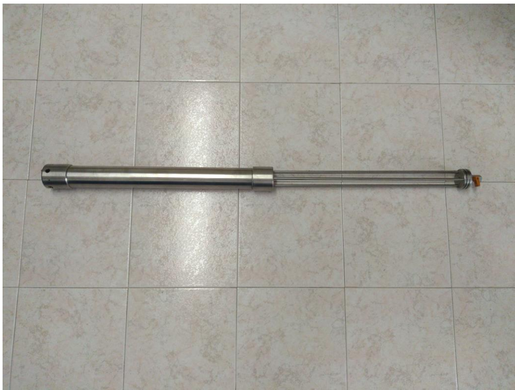
Figura 2-6 Botella para toma de muestras de agua en pozos profundos (abierta)
