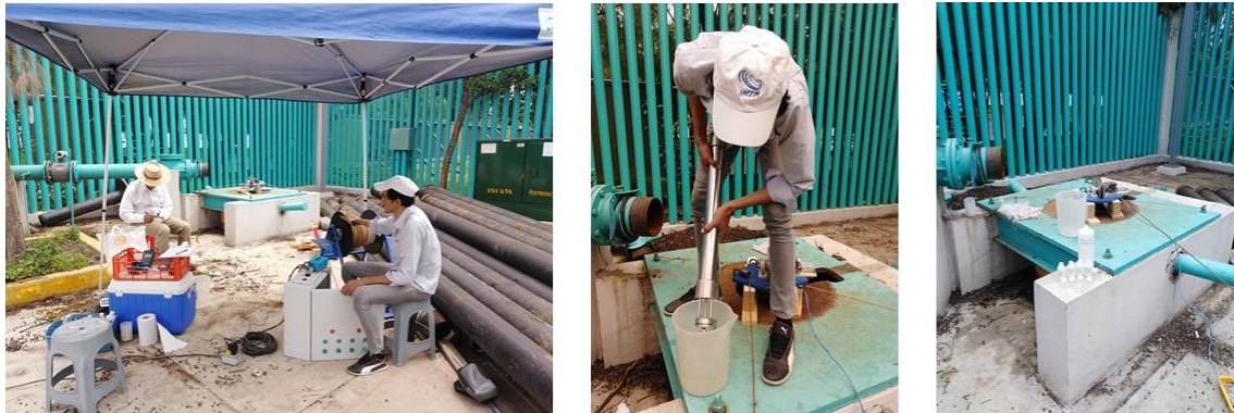
Figura 5-3 Medición de parámetros físico-químicos de campo y toma de muestras en la vertical
