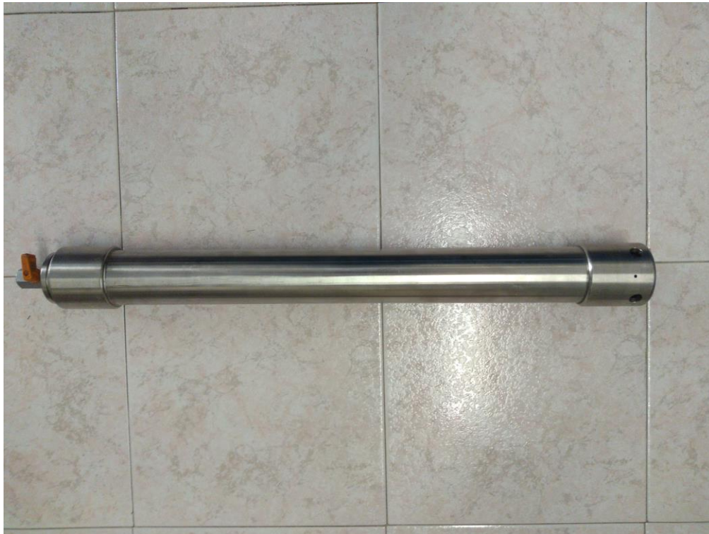
Figura 2-5 Botella para toma de muestras de agua en pozos profundos (cerrada)
