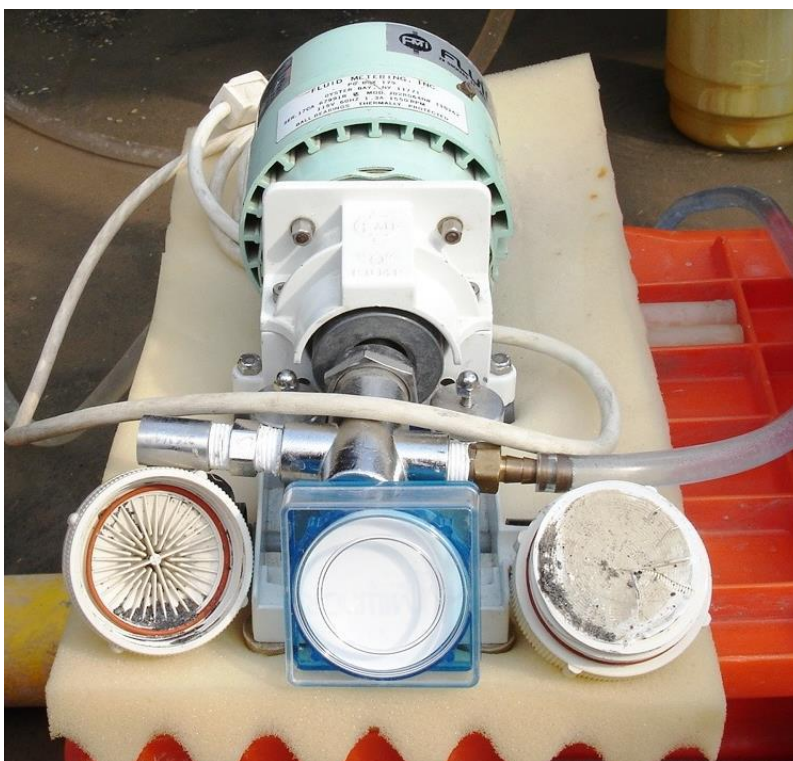
Figura 2-7 Equipo utilizado para el filtrado de las muestras de agua
