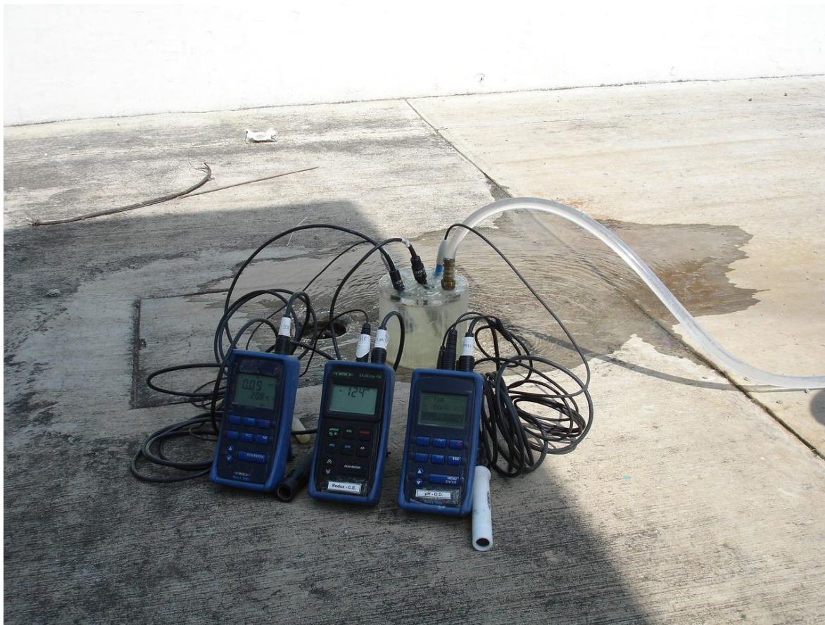
Figura 9. Dispositivos utilizados para la medición de parámetros de campo con celda de aislamiento.
