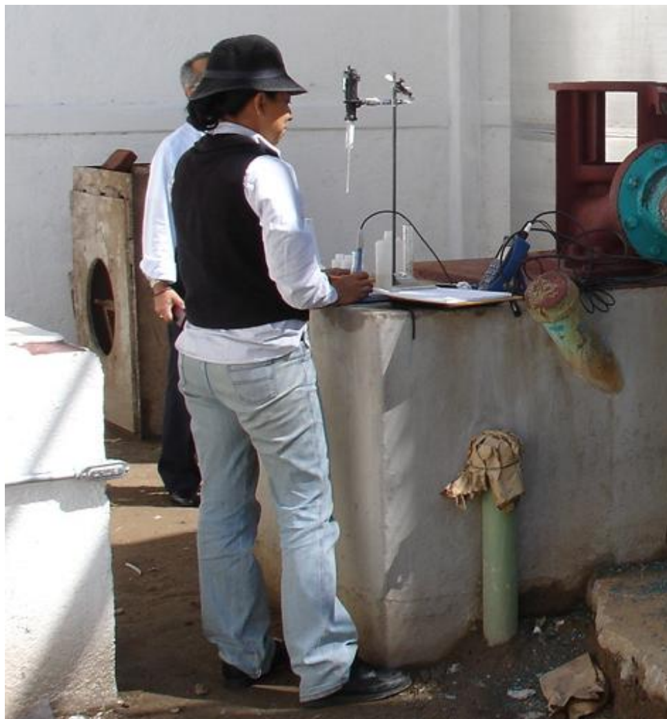
Figura 11. Ejemplo de medición de la alcalinidad total del agua subterránea mediante un titulador digital (método potenciométrico de Gran con ácido sulfúrico).
