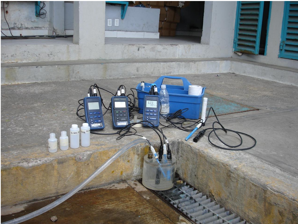
Figura 10. Electrodo para la medición de T, pH, CE, OD, y Eh con celda de aislamiento.
