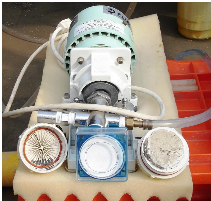
Figura 8. Equipo utilizado en el filtrado de muestras con membrana de celulosa de 0.45 micrones para eliminar las partículas de minerales que alteren la composición química de las muestras de agua.
