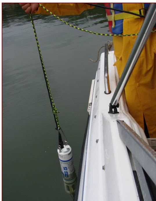
Figura 2. Medición de parámetros en agua con Hydrolab (Hach DS5)
