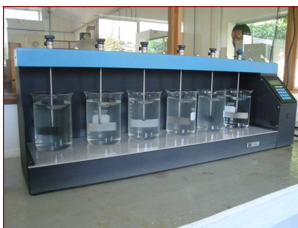
Figura 24. Montaje experimental para evaluar la dosis óptima de remoción de P-PO_4
