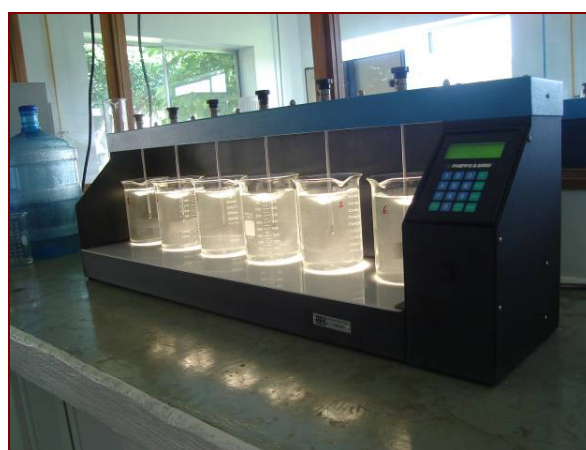
Figura 24. Montaje experimental para evaluar la dosis óptima de remoción de P-PO_4
