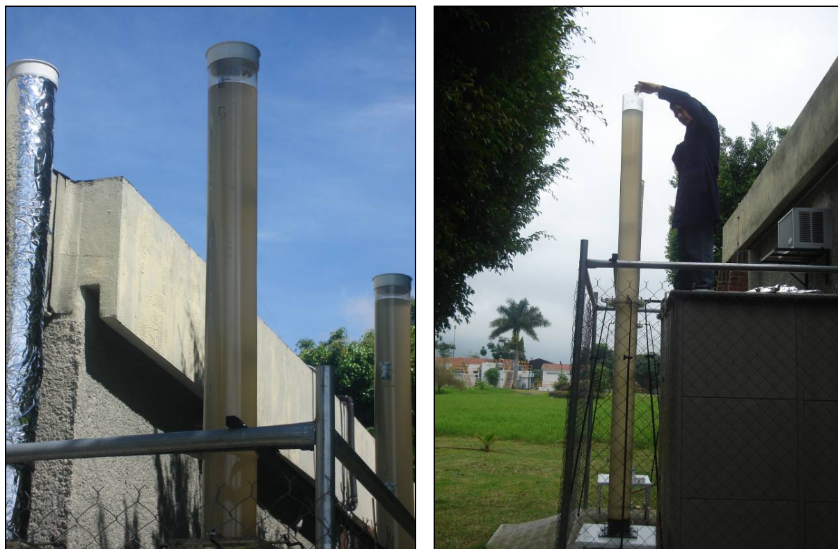
Figura 27. Montaje de columnas para evaluar la remoción de P-PO_4
