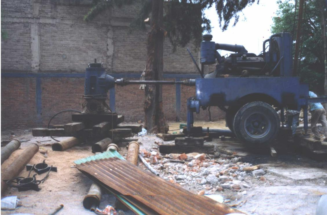
Foto N° 4.- Se observa el desmontado del equipo utilizado para las pruebas de bombeo, El cabezal y el motor están unidos por una flecha para el movimiento de los tazones de la bomba.
