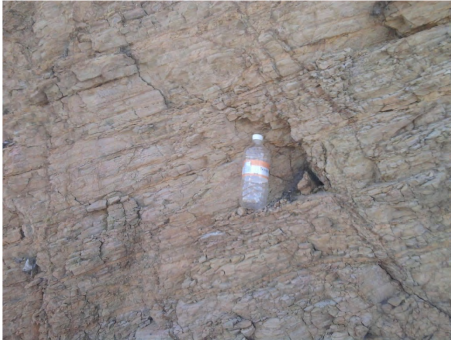
Figura 3.5 Formación Mexcala: Estratos de lutitas calcáreas, plagadas y fracturadas.
