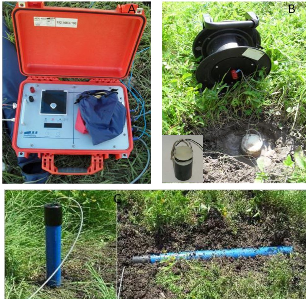
Figura 2.2 Equipo utilizado para la prospección geofísica. A) Consola ADU-07-e. B) Electrodo (EFP-06) de tipo Pb/PbCl 2 y carrete. C) Bobina de inducción magnética (MFS-06e).
