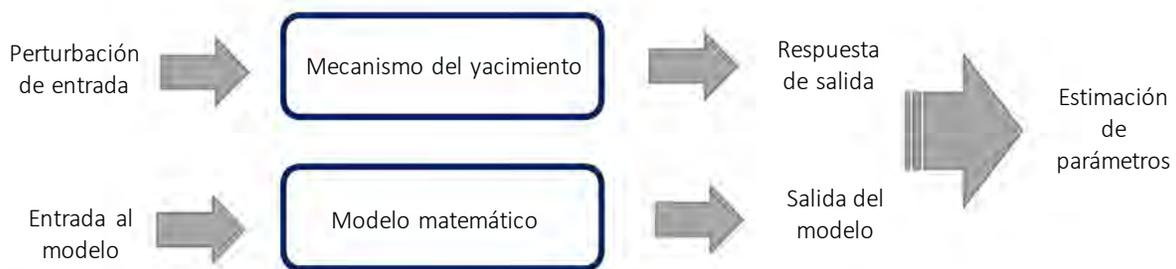
**Figura 2.1.** Esquema de la representación matemática de una prueba de presión (Modificado de Escobar-Macualó, 2003).
