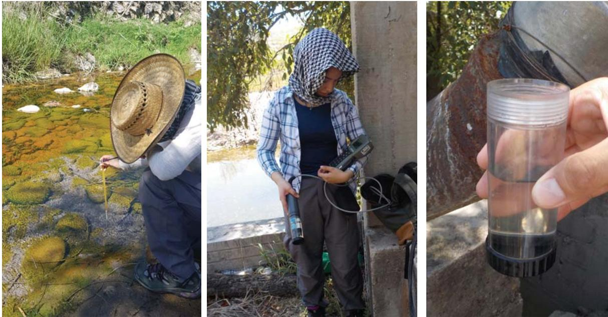
Fig. 3.4 Sondeos de campo utilizando un termómetro de mercurio, el medidor multiparamétrico HANNA HI 9828 y una toma de muestra, Julio 2019.
