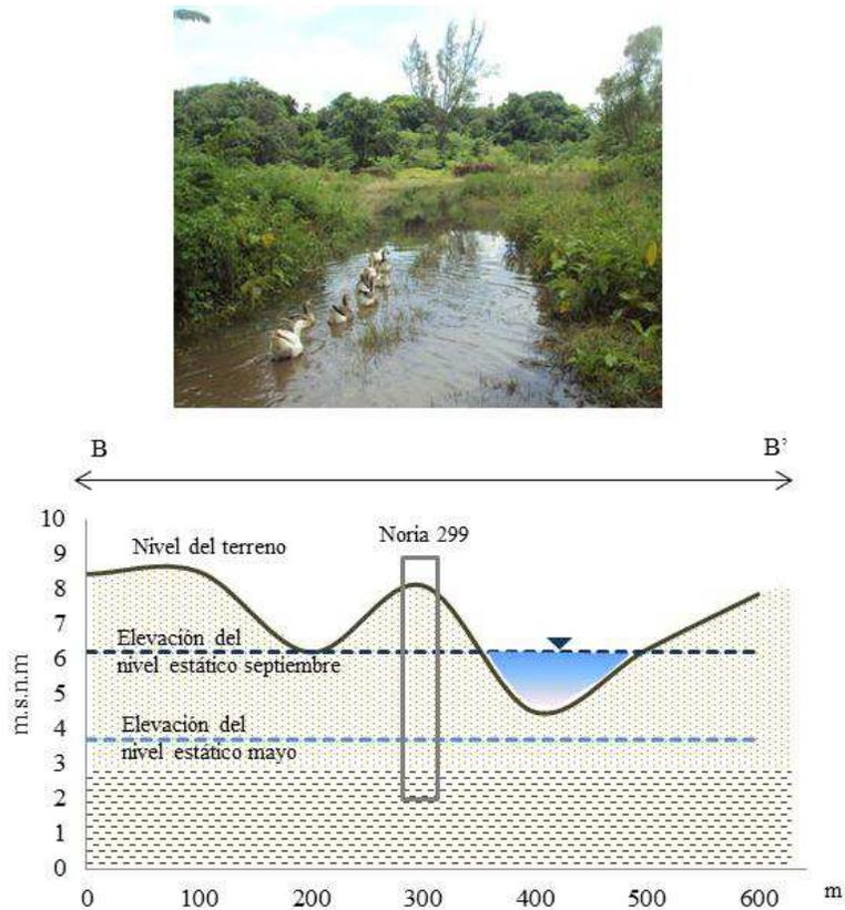
Figura 8. Noria 299 y representación de la elevación del nivel estático en secas (mayo) y lluvias (septiembre) para una sección B-B'.
