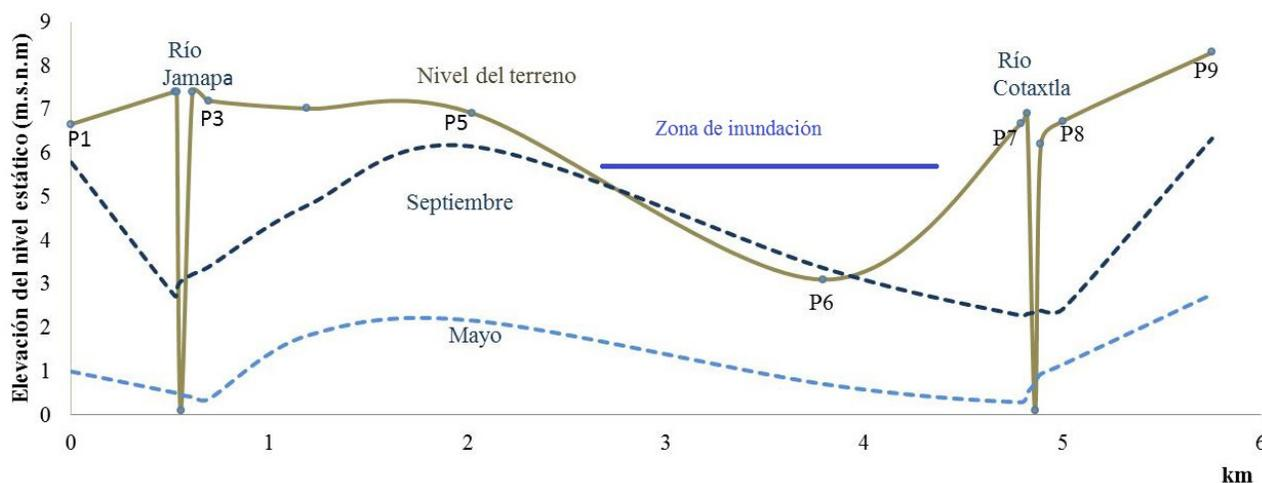
Figura 13. Variación de elevación del nivel freático en mayo y septiembre en los diferentes piezómetros (pz).
