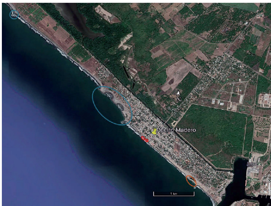
Figura 10. Espigones construidos en los últimos cuatro años (○), área del muro reforzado durante 2018 (□) y ventanas existentes que ponen en riesgo a un sector de la comunidad (□).
