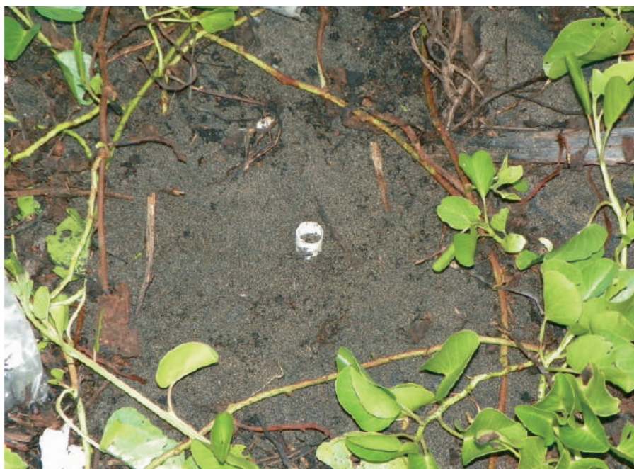
Figura 8. Punto fijo enterrado en la zona de Backshore para monitorear cambios en la línea de costa.
