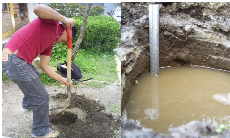
Figura 16. Medición de infiltración en la colonia Héroes Ferrocarrileros.
