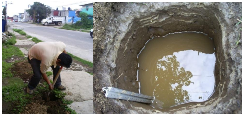
Figura 15. Medición de infiltración en la colonia Carolino Anaya.
