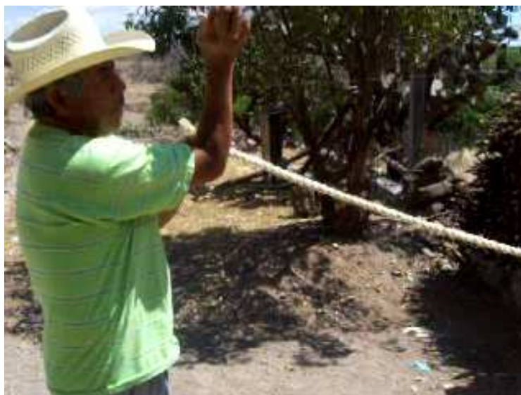
Figura 17. Técnica de torcer la cuerda con el antebrazo para la obtención de cuerda más gruesa.
