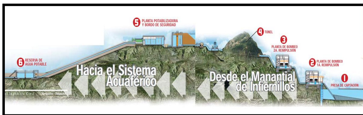
Figura 2.- Etapas de construcción del Acueducto II desde el manantial del Infiernillo hasta la reserva de agua potable. Fuente: Revista de Colegio de Ingenieros de Querétaro, (la edición de la imagen es propia).
