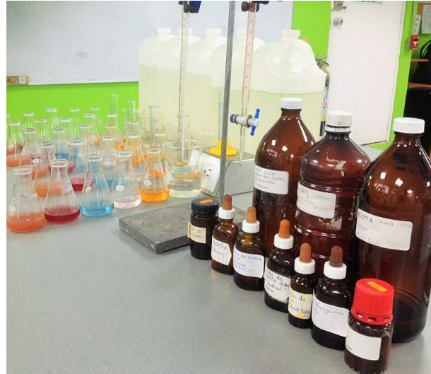
Ilustración 22. Determinación de Alcalinidad Total, Alcalinidad de Fenolftaleína, Dureza Total, Dureza Cálctica y Cloruros por métodos volumétricos. En esta ilustración se observan los colores que las muestras tomaron tras la determinación de los parámetros ya mencionados.
