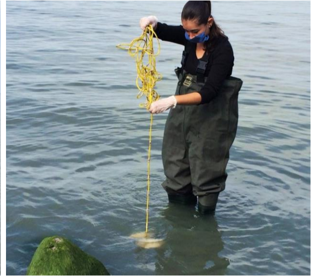
Ilustración 14. Medición de la transparencia de la orilla del lago mediante el uso de un Disco Secchi y una soga marcada cada 10 cm.
