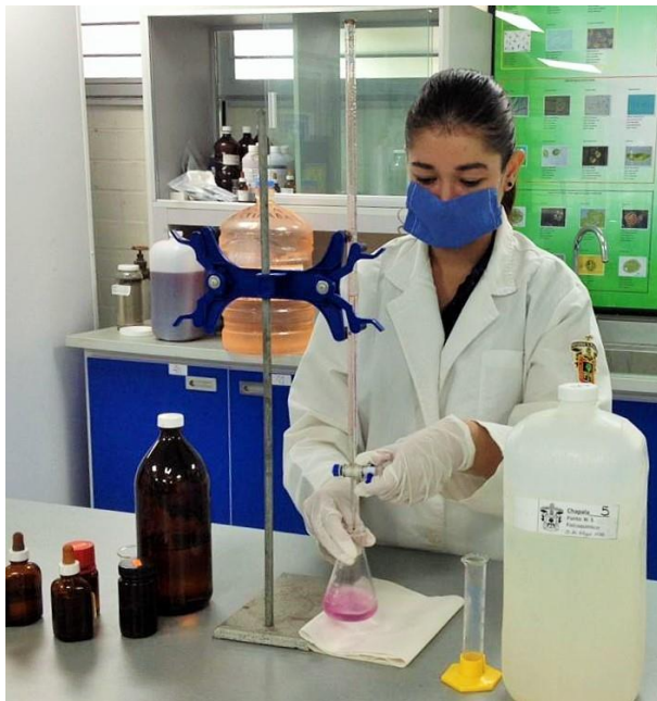
Ilustración 23. Análisis de variables físico-químicas, por métodos volumétricos (Determinación de durezas).
