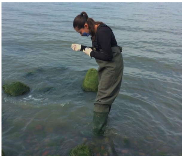
Ilustración 11. Medición del potencial de hidrogeno (pH) in situ mediante el uso de tiras reactivas marca Científica Vela Quin (CIVEQ®).
