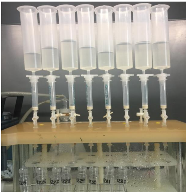
Ilustración 26. Filtración de las muestras colectadas en los cartuchos Oasis HLB previamente acondicionados.
