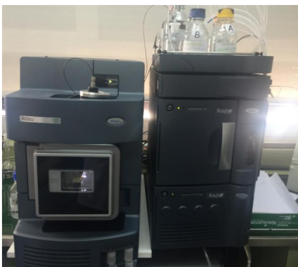
Ilustración 28. Cromatógrafo ACQUITY UPLC H-Class PLUS con bomba cuaternaria, acoplado a un detector de masas de triple cuadrupolo (MS/MS) Xevo™ TQD, marca WATERS®.
