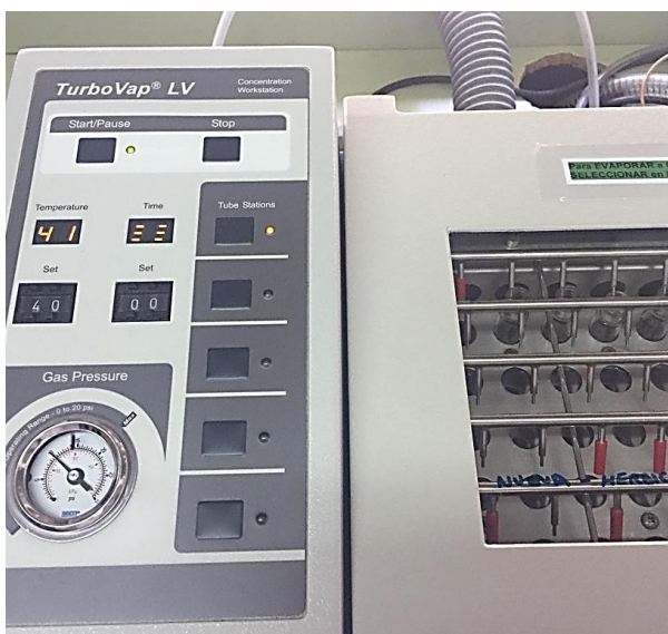
Ilustración 27. Inyector de Nitrógeno marca TurboVap® LV para llevar a sequedad las muestras a 40°C.
