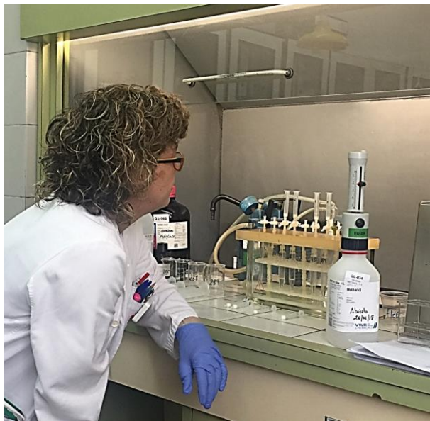
Ilustración 25. Acondicionamiento de los cartuchos cartucho Oasis HLB para la extracción en fase sólida y determinación de microcistinas en el Laboratorio de Salud Pública de Navarra, España.
