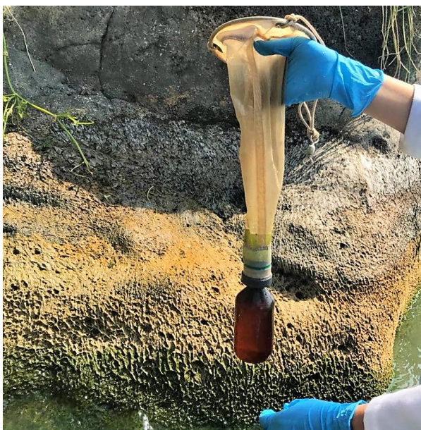
Ilustración 20. Muestra para la Determinación del Fitoplancton del punto 1, donde se observa la concentración del fitoplancton en la malla después del filtrado.
