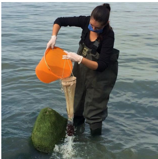
Ilustración 19. Toma de muestra destinada a la determinación del Fitoplancton en el punto de muestreo 3, mediante la filtración de un volumen de 100 L por una malla de 45 \mu\text{m} .
