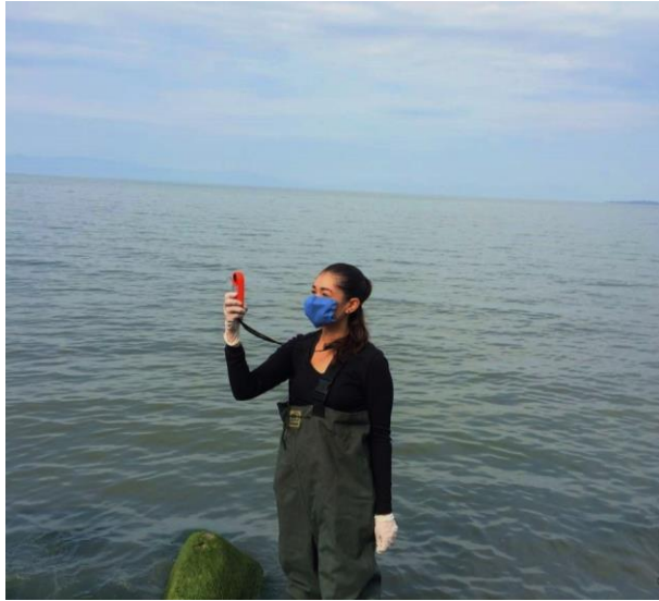
Ilustración 13. Medición de parámetros atmosféricos in situ mediante el uso de una estación meteorológica portátil marca Kestrel K-4500®
