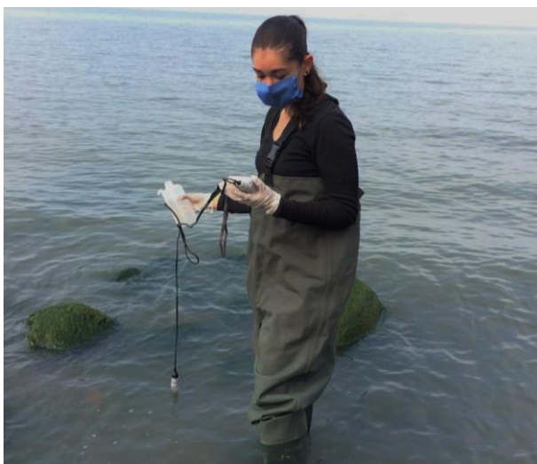
Ilustración 12. Medición in situ de la temperatura (°C) y la concentración de oxígeno disuelto (OD mg/L) mediante el uso de un oxímetro HORIBA® modelo HB-OM-51-2.
