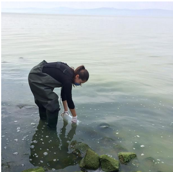
Ilustración 18. Toma de muestra destinada al análisis de parámetros Fisicoquímico del punto 4. Cabe señalar que se observa una ligera floración algal en la parte inferior izquierda de la fotografía.
